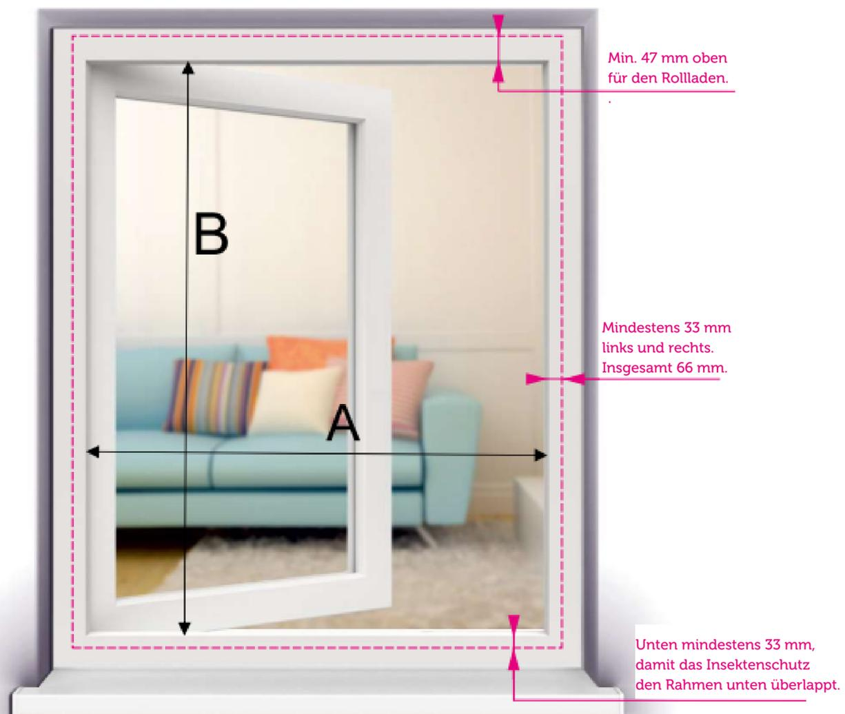
Öffnen Sie den Flügel und messen Sie die Breite des äußeren Fensterrahmens wie in der Abbildung gezeigt.
