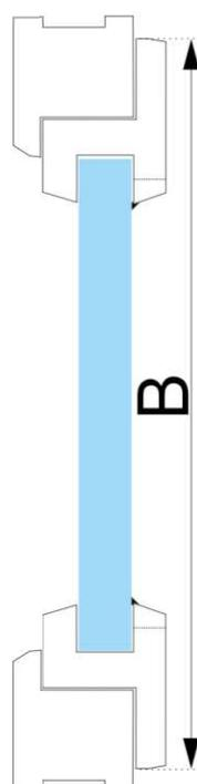
Überprüfen Sie beim Messen der Breite den Abstand zwischen den Außenkanten des Rahmens um das Glas. Abb.1
