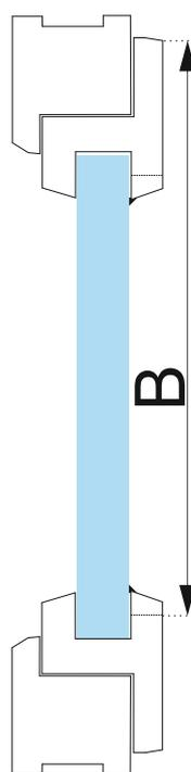
Bei der Höhenmessung das Maß zwischen Flügeloberkante und Glasleistenunterkante prüfen. Abb. 3
