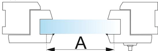
Bei der Breitenmessung den Abstand der Außenkanten der Glasleiste prüfen. Abb. 1, 2.
