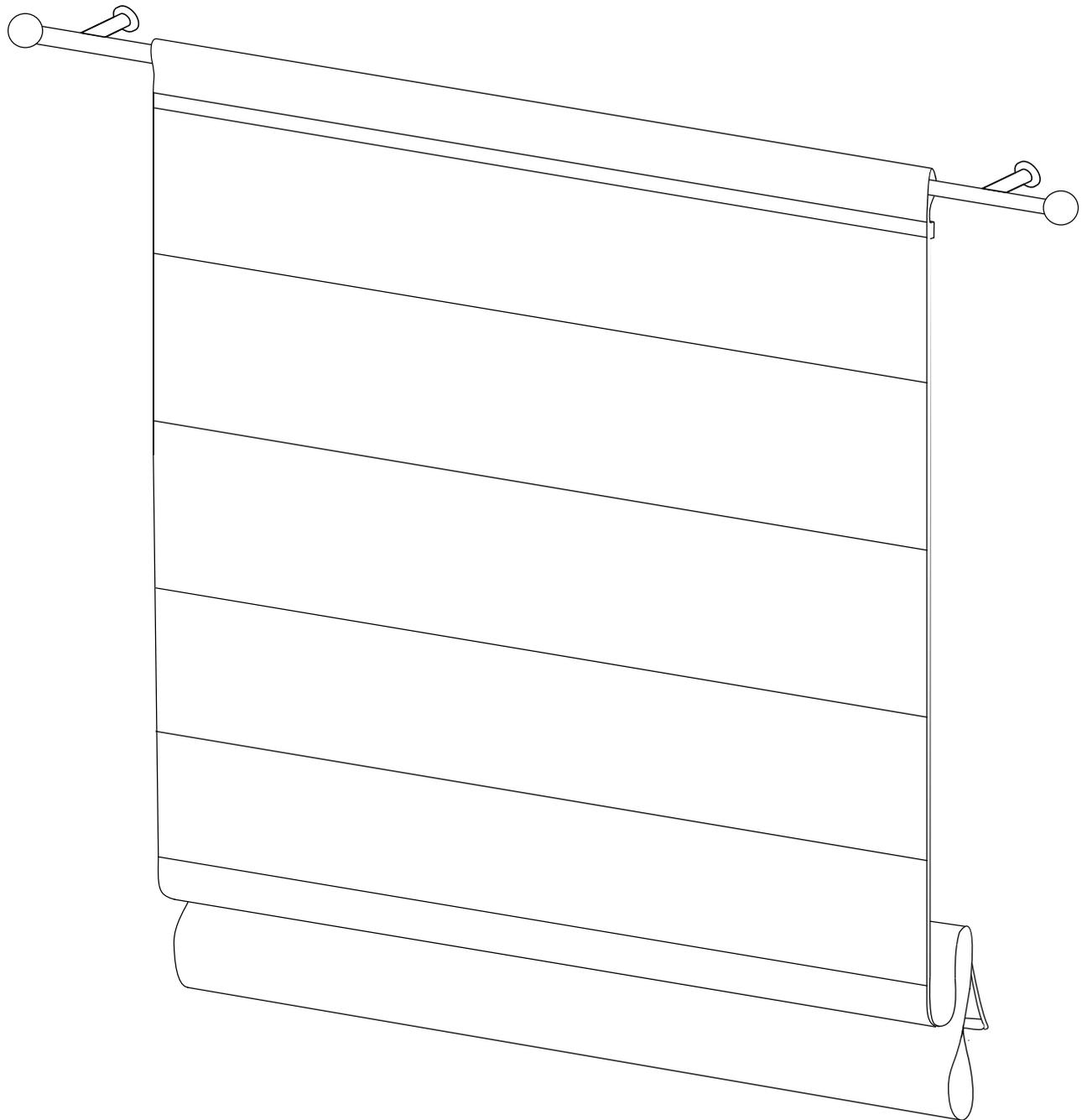
Befestigen Sie den Seilclip in unmittelbarer Nähe des Rollladens. Ziehen Sie das Rollo an der Schnur hoch und runter. Das Rollo stoppt, wenn die Schnur in einer Acht am Schließblech verknötet ist.
