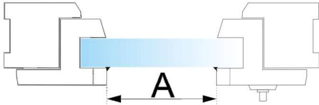
Überprüfen Sie durch Messen der Breite die Abmessung des Glaslichts, das an der breitesten Stelle gemessen wird.
