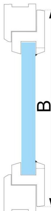
Überprüfen Sie beim Messen der Breite den Abstand zwischen den Außenkanten des Rahmens um das Glas. Abb.1,2
